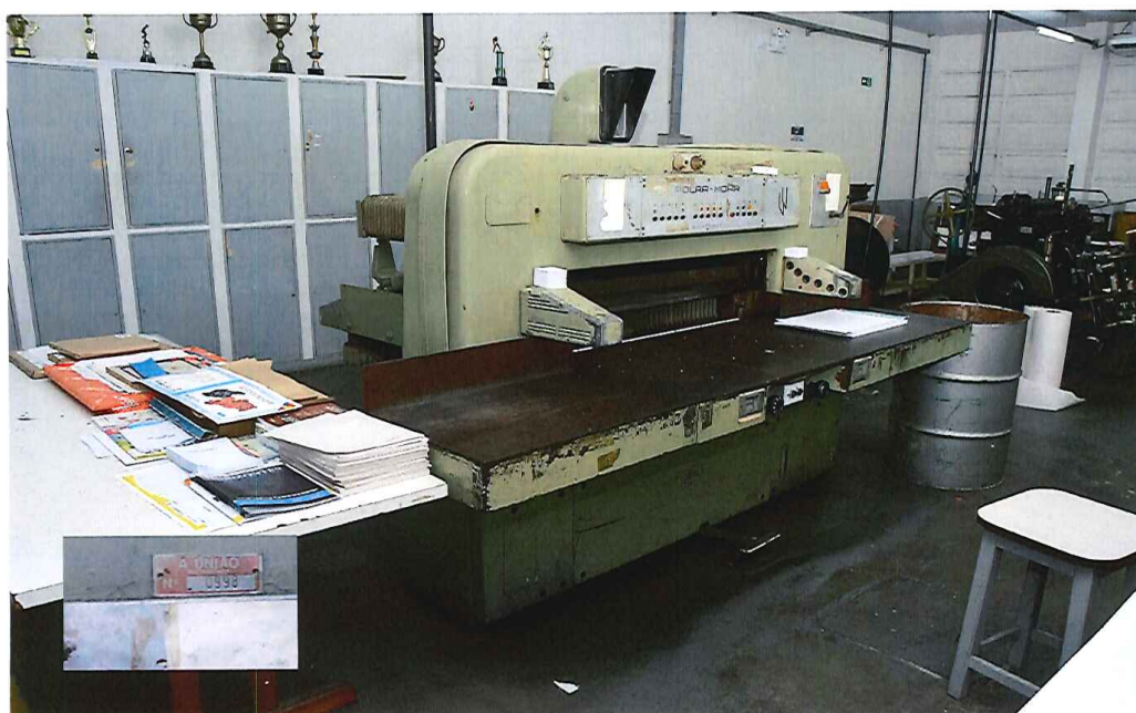
Maquina FACÃO POLAR: para corte inicial e final, Tombamento nº 09982
