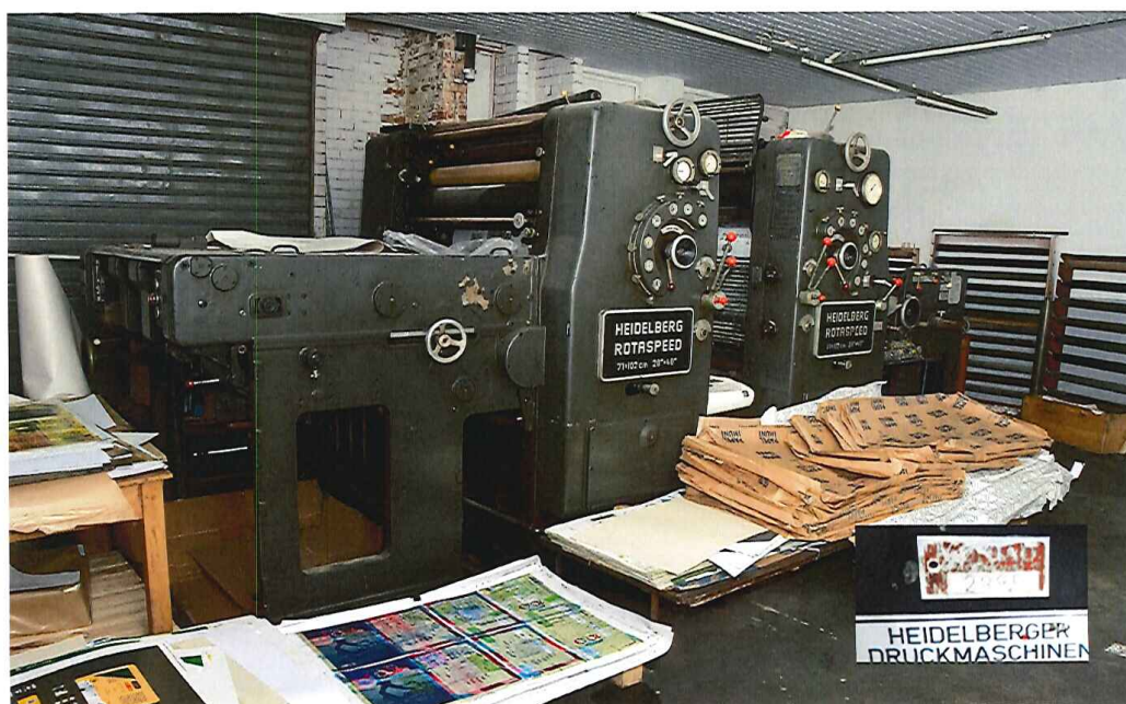
Maquina ROTASPEED: impressora bicolor, Tombamento nº 2895
