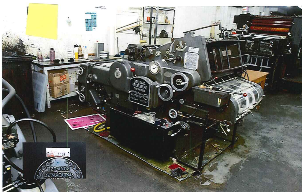
Maquina KORD: impressora formato 1/2 de folha, Tombamento nº 1029
