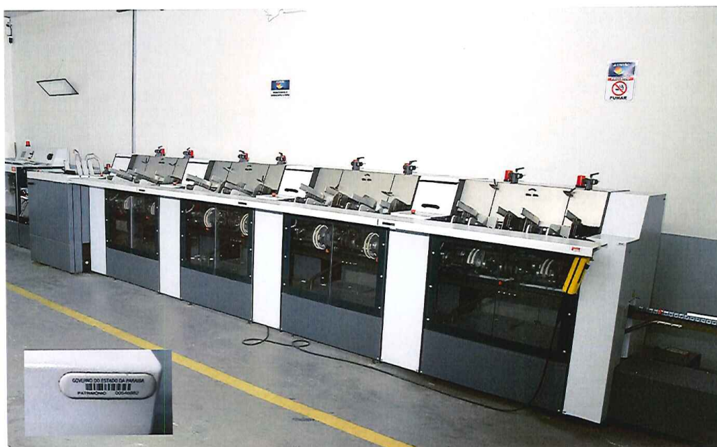
Maquina ALCEADEIRA: intercala, grampeia e refila, Tombamento nº 00548882
